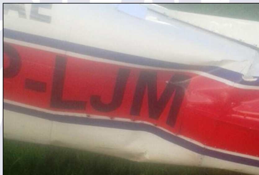
Figura 3 - Danos ao cone de cauda da aeronave.
