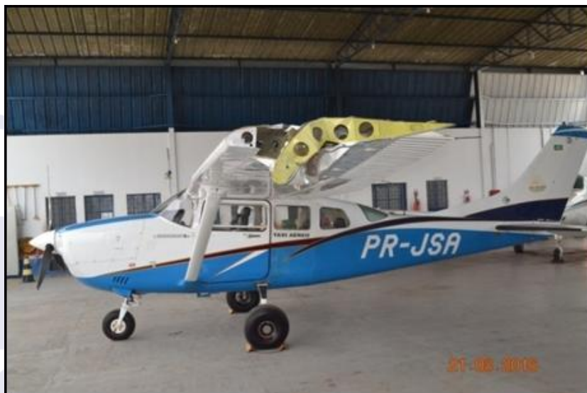
Figura 2 - Danos na ponta da asa esquerda.
