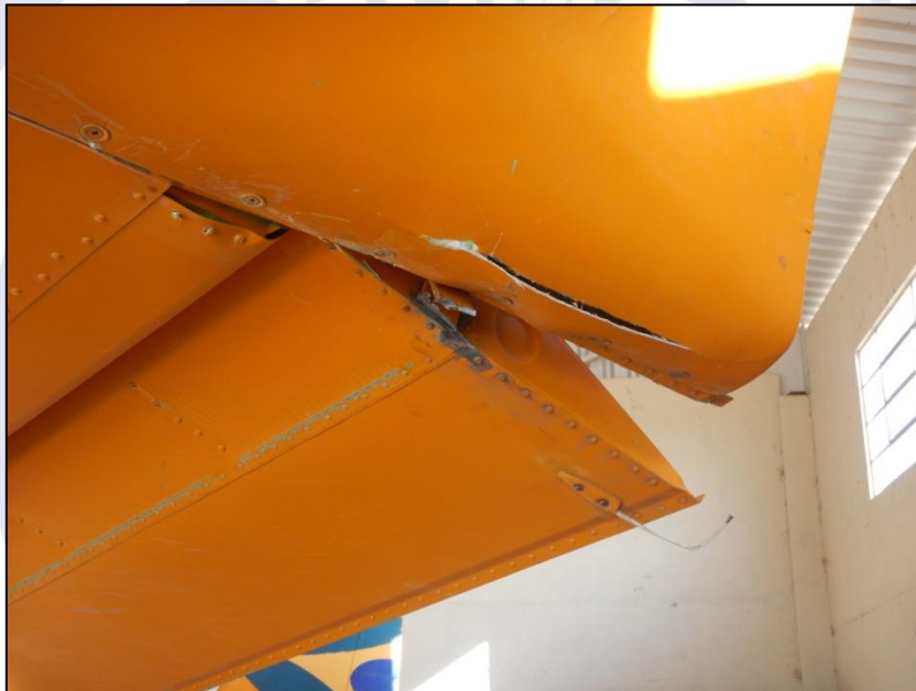
Figura 3 - Dano no aileron esquerdo.
