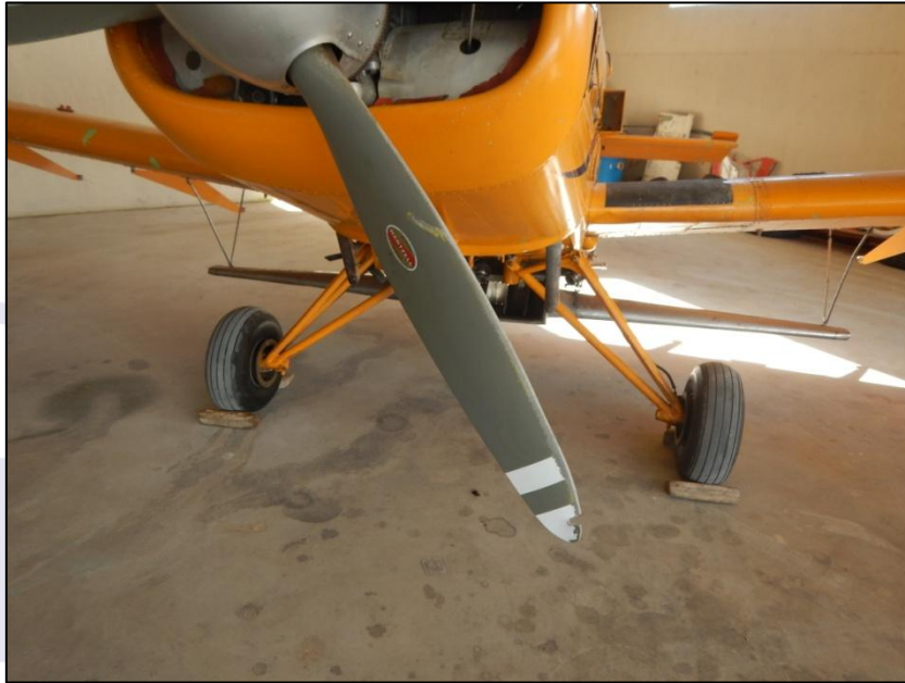
Figura 2 - Dano na ponta da pá da hélice.
