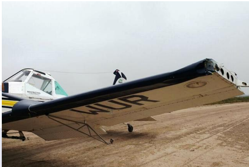
Figura 2 - Danos na ponta da asa esquerda.
