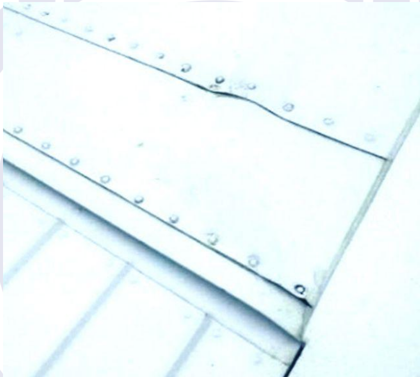
Figura 3 - Dano na raiz da asa esquerda.
