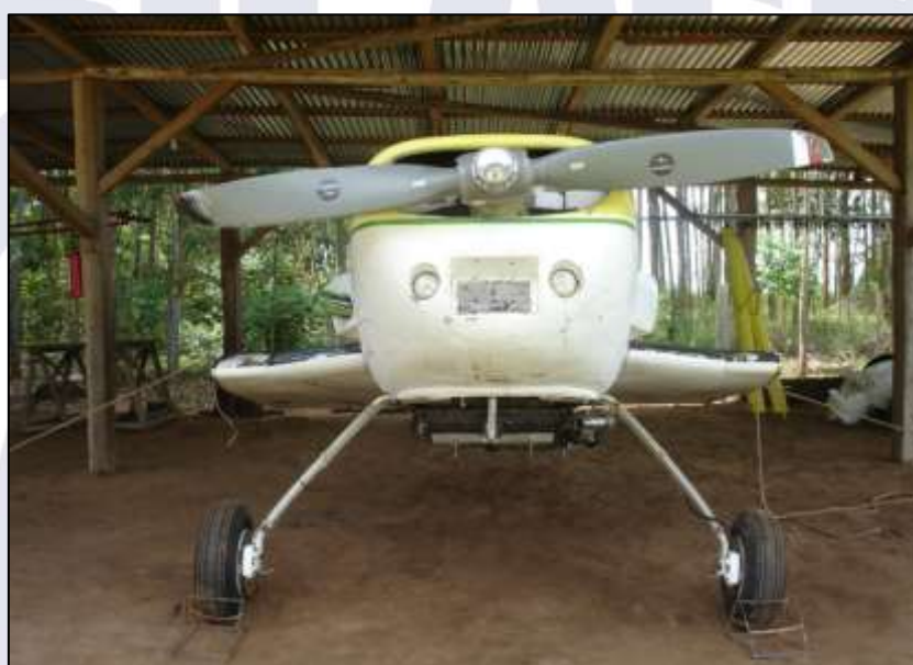
Figura 4 – aeronave com trem de pouso instalado e asas removidas.
