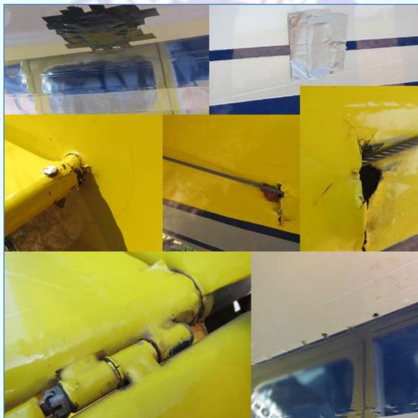
Figura 10 - Mosaico de não conformidades (da esquerda para a direita, a partir do alto): fita adesiva no intradorso, fita metálica na lateral, parafuso de fixação do profundor com corrosão, atrito do cabo do leme rompendo a entelagem nas laterais, roçamento do mecanismo de fixação do profundor (tinta retirada), parafusos faltantes no intradorso.
