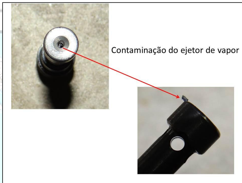
Figura 3 - contaminação do ejetor de vapor.
