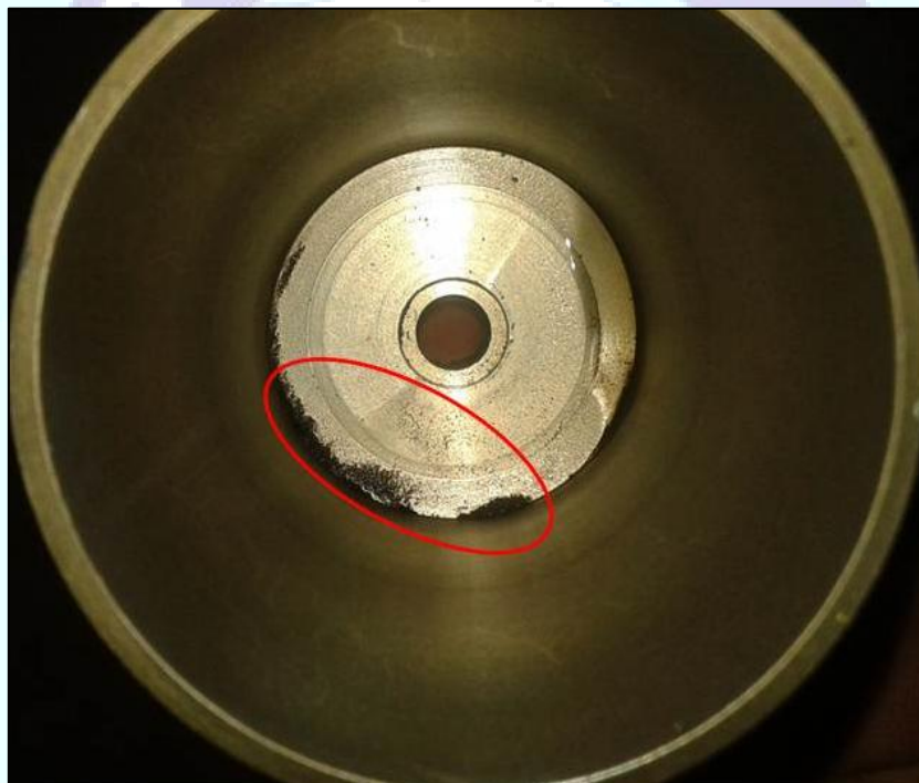
Figura 2 - Sujidade no interior do filtro de combustível.
