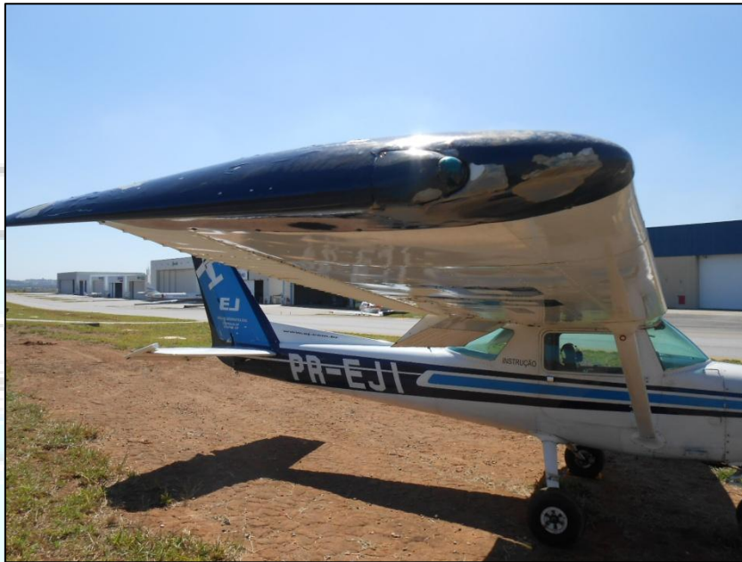
Figura 2 – Dano na ponta da asa direita.
